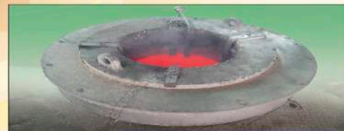
名稱：坩堝型鹽浴爐 用途：加熱、淬火 有效工作區域： ● ∅ 700 x H2500 ● ∅ 600 x H1200
