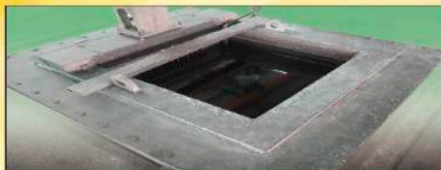
名稱： ● 方型鹽浴回火爐 ● 方型溫浴回火爐 ● 方型低溫爐 用途：預熱、回火、應力消除 有效工作區域： ● L1100 x W1100 x H2500 ● L 850 x W 750 x H2200 ● L 800 x W 800 x H1500
