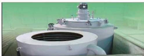
名稱：坩堝型氮化爐 用途：氣體氮化 有效工作區域：∅ 650 x H1200
