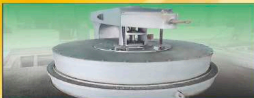
名稱：坩堝型熱風爐 用途：預熱、回火、應力消除 有效工作區域： ∅ 1200 x H2600
