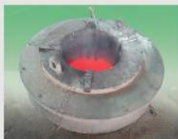
坩堝型鹽浴爐
