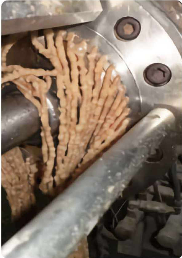
▲ 雙軸擠壓膨發設備
