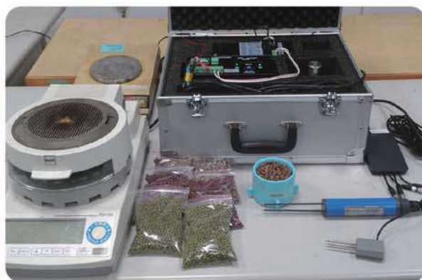
▲ 雜糧高含水率檢測系統之關鍵組件及驗證設備
