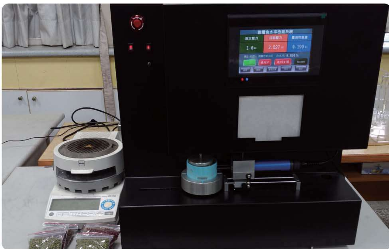
▲ 雜糧高含水率與檢測系統之展示機-配置壓實機，提升落花生等雜糧水分檢測速度至5分鐘以內及含水率檢測範圍提高至65%
